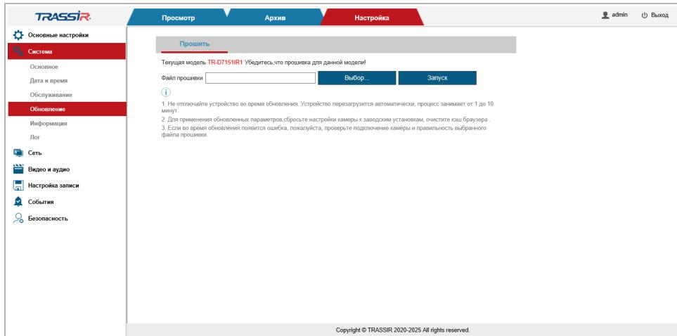
Для обновления программного обеспечения (прошивки) IP-камеры нажмите кнопку Путь [Browse] в блоке Прошить [Upgrade] и укажите файл с программным обеспечением. Чтобы начать загрузку файла, нажмите кнопку Запуск [Upgrade].
