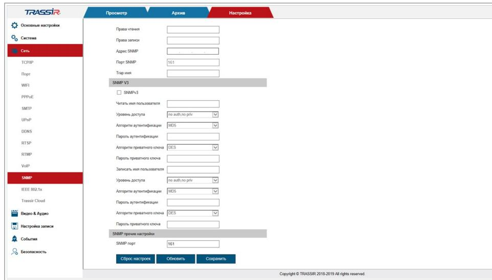
Чтобы активировать функцию, установите флаг соответствующий версии SNMP (**SNMPv1 [SNMPv1]**, **SNMPv2c [SNMPv2]** или **SNMPv3 [SNMPv3]**) и настройте параметры, используемые протоколом.
