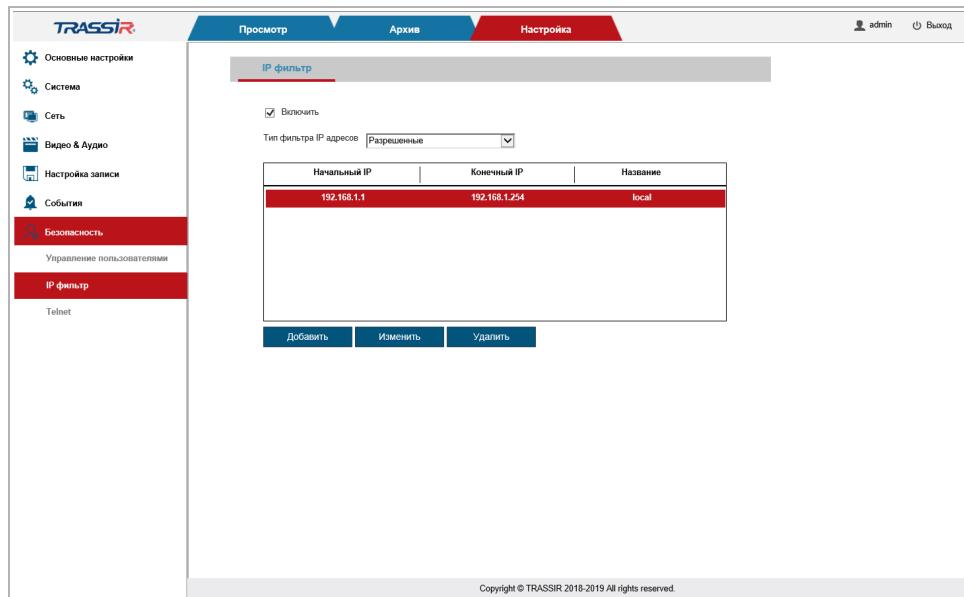
Используя настройки фильтра по IP можно ограничить доступ к IP-камере с одного или нескольких сетевых устройств.
