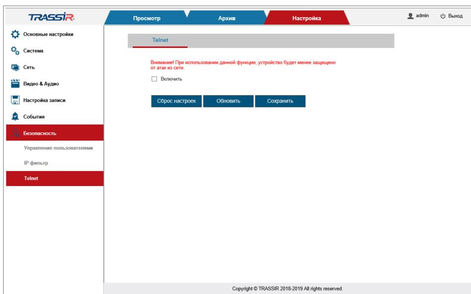
Установите флаг **Включить [Enable]** чтобы разрешить удалённое подключение к камере.
