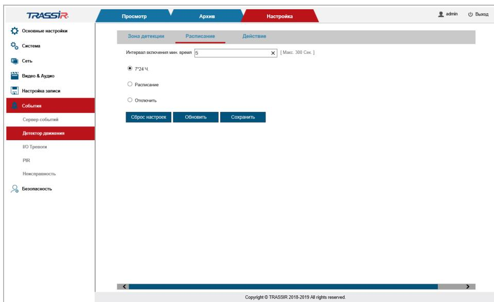
В поле **Интервал включения мин. время [Trigger Interval Min. time]** установите время, по которому будет определяться наступление события, от **0** до **300** сек. Если тревожное событие длится меньше указанного времени, то оно считается не наступившим.
