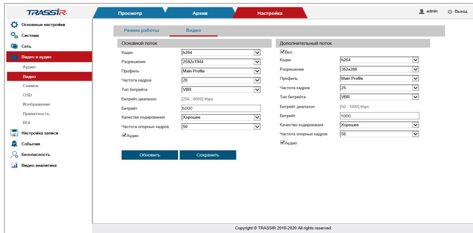
В блоке **Вторичный поток [Sub stream]** установите флаг **Включить [Enable]**, чтобы включить настройку субпотока.
