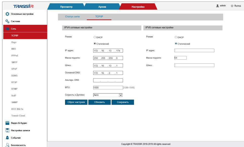
Перед началом настройки выберите для какой версии протокола будет производиться настройка: **IPv4** или **IPv6**.
